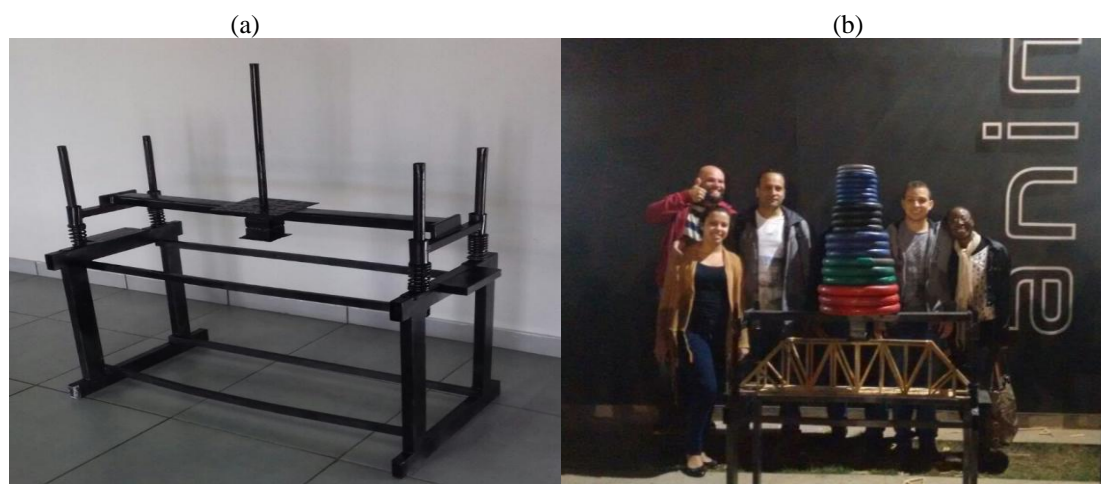
Figura 4 - Prototipagem final bancada de ensaio destrutivo de carga (a) e o Dispositivo na competição de Ponte de Palitos do Centro Universitário de Belo Horizonte –UniBH (b).
