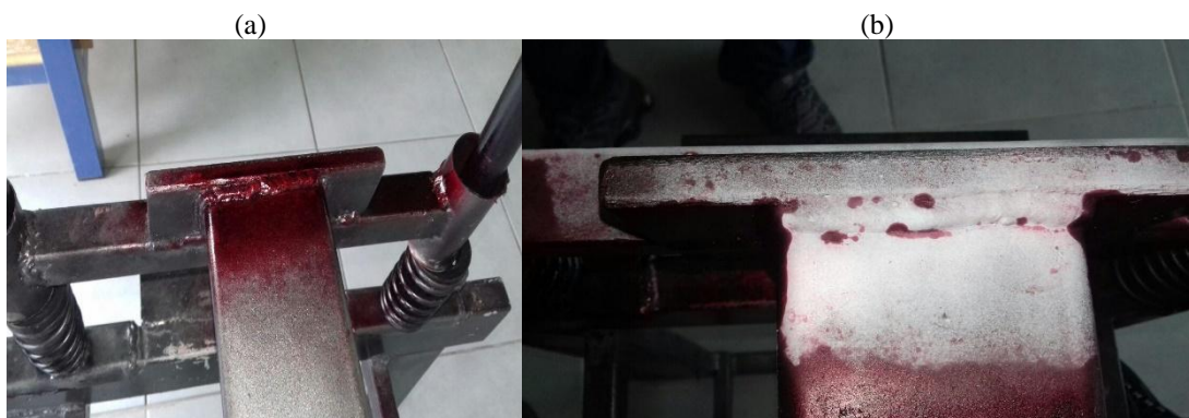
Figura 4 - Aplicação de líquido penetrante (a) Aplicação de Líquido Revelador (b).
