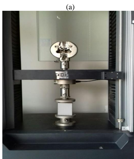
Figura 1 – Ensaio de compressão no Metalon (a) e Curva de tensão x Deformação (b).
