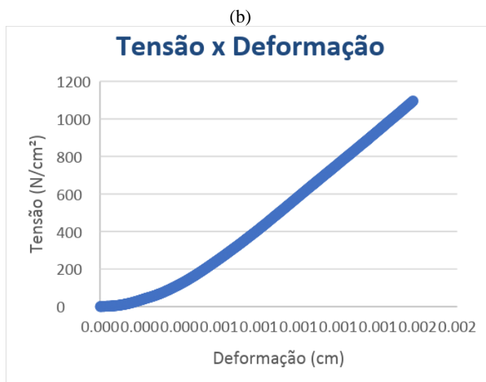
Figura 1 – Ensaio de compressão no Metalon (a) e Curva de tensão x Deformação (b).
