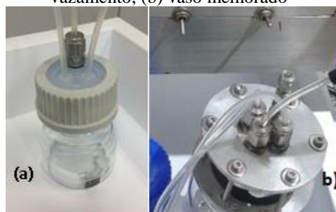
Figura 4 – (a) vaso com tampa que apresentou vazamento, (b) vaso melhorado
