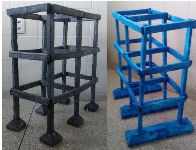
O Pórtico 1 teve suas ligações viga-pilar feita através de cola, para proporcionar maior rigidez nas ligações e conseqüentemente menores deslocamentos na estrutura. O Pórtico 2 teve suas ligações viga-pilar feita através de clipe de papel (Figura 3), deixando todas as ligações rotuladas, possibilitando ao Pórtico 2 grandes deslocamentos dos seus elementos.
