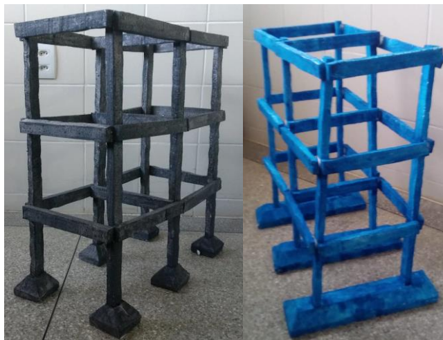
Figura 2: Pórtico com ligações rígidas (a), Pórtico com ligações rotuladas (b).
