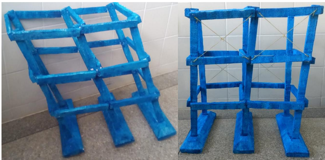
Figura 4- Pórtico 2 sem contraventamento (a), Pórtico 2 com contraventamento (b).
