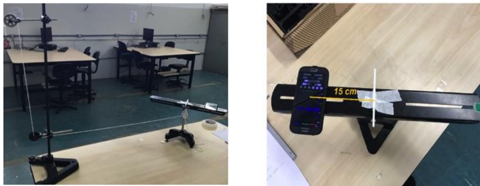
Figura 4 – (A): Experimento utilizando o acelerômetro. (B): Perfil durante o experimento.
