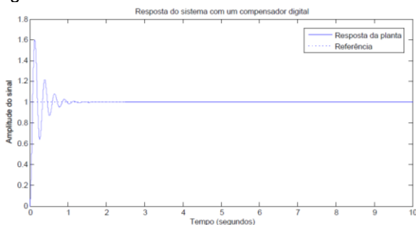
Figura 3 Resposta do sistema de controle digital ideal. Fonte: Autoria Própria
