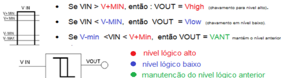
Figura 2 – Condicionamento da leitura dos pulsos representando vazão por disparador Smith-Trigger
