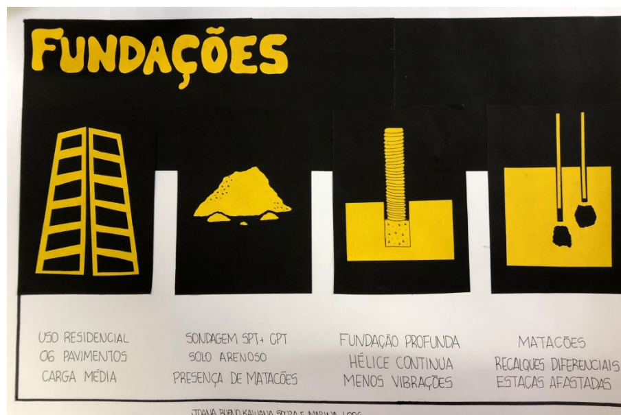
Figura 6 – Painel 6: Edifício residencial, estacas hélice contínua.
