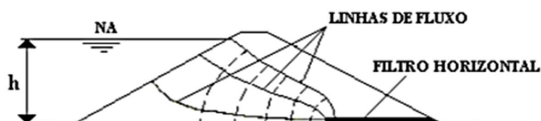
Figura 1 – Rede de fluxo de uma barragem de terra.
