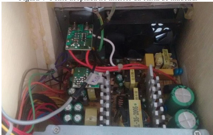
Figura 4- Fonte acoplada no interior da caixa de madeira.
