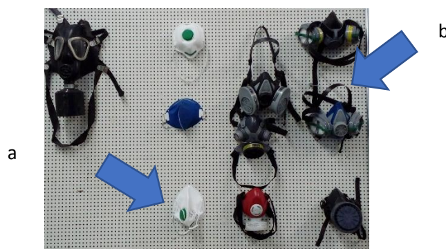
Figura 5: Vista do painel de exposição de EPIs - grupo de proteção respiratória mostrando detalhes: (a) respiradores sem manutenção e (b) respiradores com manutenção.
