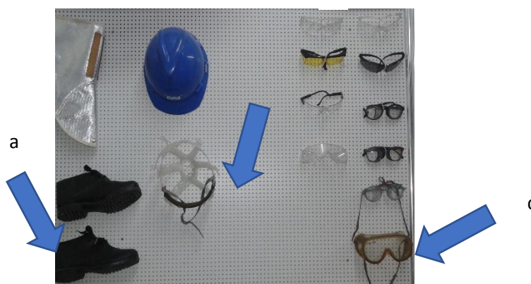
Figura 3. Quadro expositivo de EPIs - grupos de proteção dos membros inferiores e proteção da cabeça e face mostrando detalhes: (a) botina de couro; (b) carneir b ástica e c) óculos de proteção.
