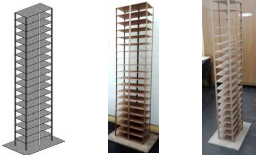
Figura 2 - Modelo construído em laboratório com 19 pavimentos em HDF.
