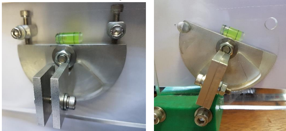
Figura 3 – Configuração do apoio como engastado (esquerda) e como apoio de segundo gênero (direita).
