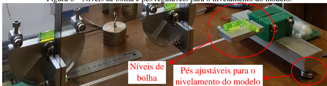
Figura 6 – Níveis de bolha e pés reguláveis para o nivelamento do modelo.
