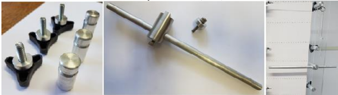
Figura 4 – Detalhe das roldanas utilizadas no sistema de aplicação de cargas horizontais (esquerda), detalhe do limitador de deslocamento (centro) e fixação das roldanas e do limitador de deslocamento na reentrância vertical da placa de acrílico (direita).
