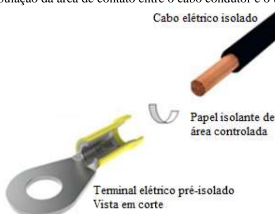
Figura 2 - Manipulação da área de contato entre o cabo condutor e o terminal pré-isolado.
