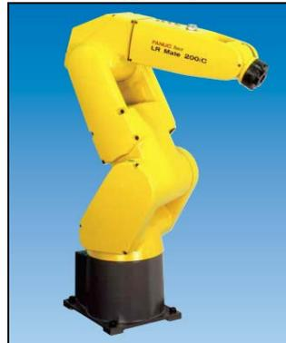
O robô Fanuc LR Mate 200iC tem como características: 6 eixos rotativos, carga máxima de trabalho de 5kg, alcance de 704mm com repetibilidade de  $\pm 0,02$ mm, massa total de 72kg e freio mecânico em todas as seis juntas.
