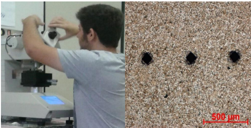
Figura 3 – Ensaio de microdureza sendo realizado nos espécimes em estudo.
