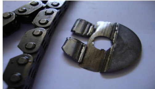
Figura 5 - Arruela lisa que falhou devido ao cisalhamento
