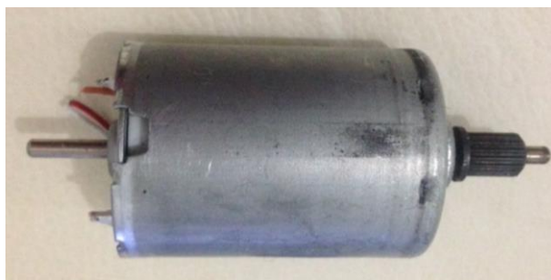
Figura 3: Motor CC retirado de impressora.
