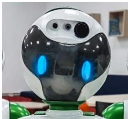
O robô Beo conta ainda com um sensor de toque instalado no topo de sua cabeça. Por ser um sensor capacitivo, este pode perceber quando alguém o toca, e dessa forma pode
