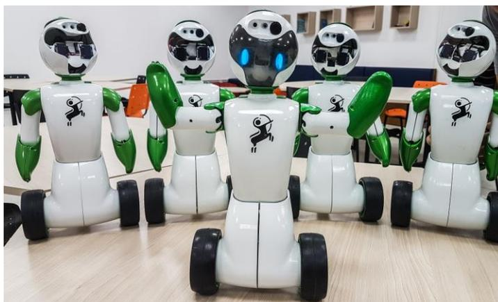
O robô interage com humanos através de gestos, através de movimentos das rodas, por meio de sons, e através de expressões faciais. Além disso, ele é capaz de detectar presença por proximidade por meio de sensor de toque na cabeça e câmera (por exemplo, detecção de rostos).
