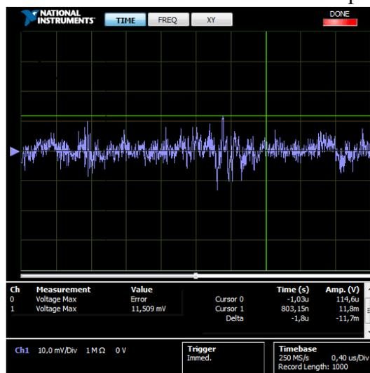
Para a análise dos resultados na tensão de operação (0,5 V) verificou-se as medidas em acoplamento CA/CC de modo que as componentes em alta frequência possuem um pico de 10,7 mV que já tem um valor razoavelmente significativo em relação a componente contínua, entretanto este valor mostra a contribuição já presente sem o segundo circuito ativo. As Figuras 11 e 12 apresentam as medidas realizadas.
