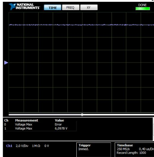
Figura 11 – Componentes de tensão com fonte em 0,5V - Acoplamento CA - VISIR.
