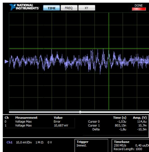
Com os parâmetros iniciais definidos, os circuitos foram colocados em operação para a análise dos efeitos em comparação a operação sem a presença do gerador de funções, sendo que obtiveram-se componentes muito maiores na componente alternada da fonte CC, com picos de 205,04 mV aplicando 500 mV. As Figuras 13 e 14 apresentam as medidas realizadas.
