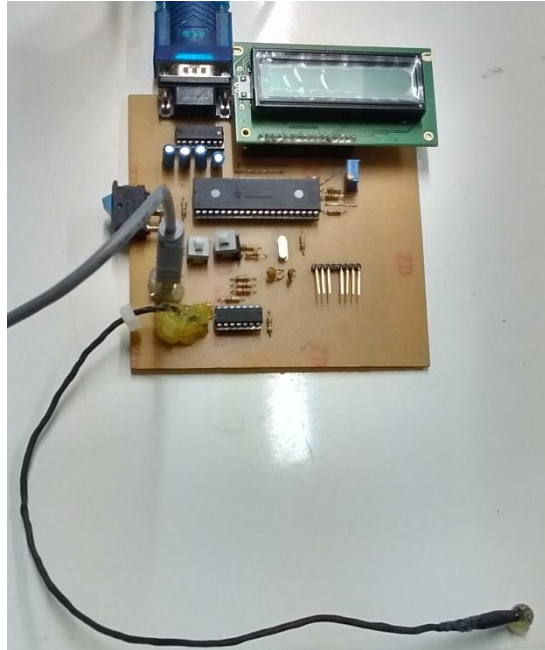
Figura 1 – Equipamento Desenvolvido: Termômetro Digital e Software .
