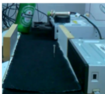
Figura 7 – drives de CD usados como atuadores
