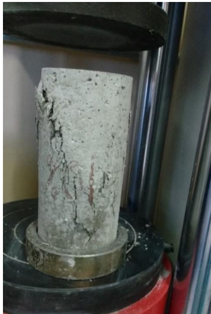
FIGURA 01 – Concreto com adição 30% de PET
