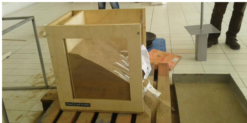
Figura 3 – Talude após a ruptura
