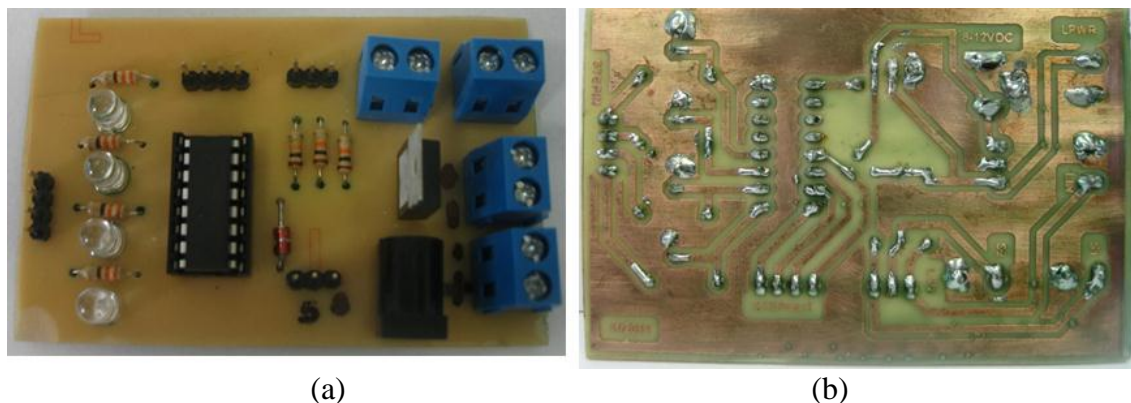
Figura 6 – (a) Vista frontal da placa de sensores. (b) Trilha da placa de sensores
