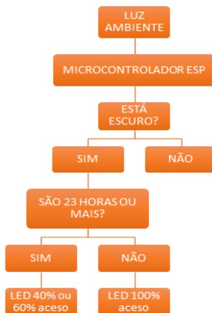
O sistema de gerenciamento realiza a leitura da tensão no LDR, a qual foi relacionada a um nível de iluminância mensurada pela caracterização do sistema. Quando esse nível estiver entre 170 e 300 lux, o sistema começa a atuar no LED, por meio do ajuste do *duty cycle* do PWM, de acordo com a leitura de tensão no LDR. Após alcançar 100%, o *duty cycle* permanecerá nesse valor até às 23h.
