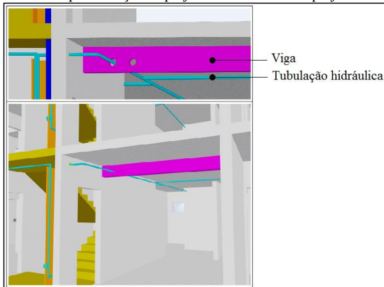
Figura 3 – Compatibilização de projeto hidráulico com o projeto estrutural.
