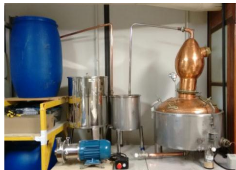
Figura 2 - Alambique de cobre acoplado a um condensador em aço inox - destilação
