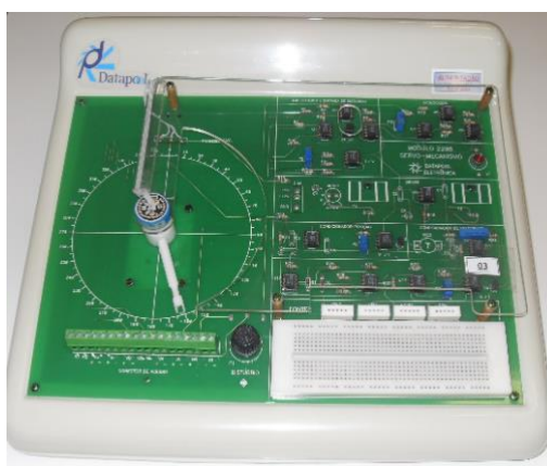
Figura 1 – Módulo Didático Datapool Servomecanismo
