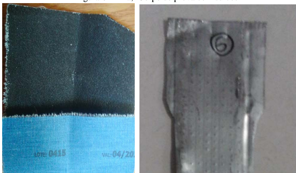
Figura 6 - Lixa; Corpo de prova com sulcos
