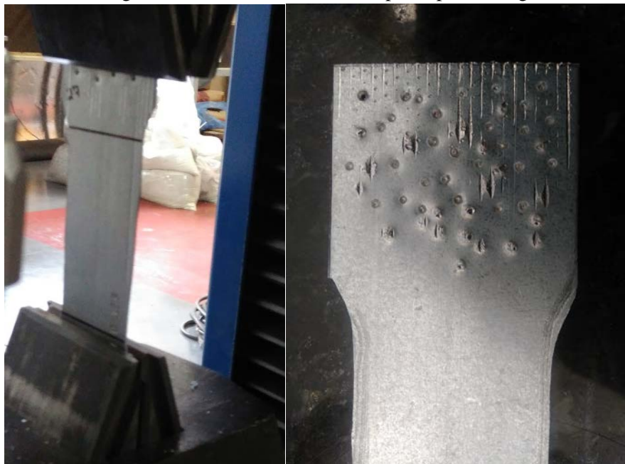
Figura 4 - Deslizamento entre corpo de prova e a garra
