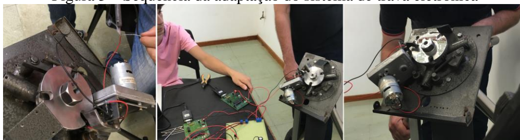
Figura 5 – Sequência da adaptação do sistema de trava eletrônica
