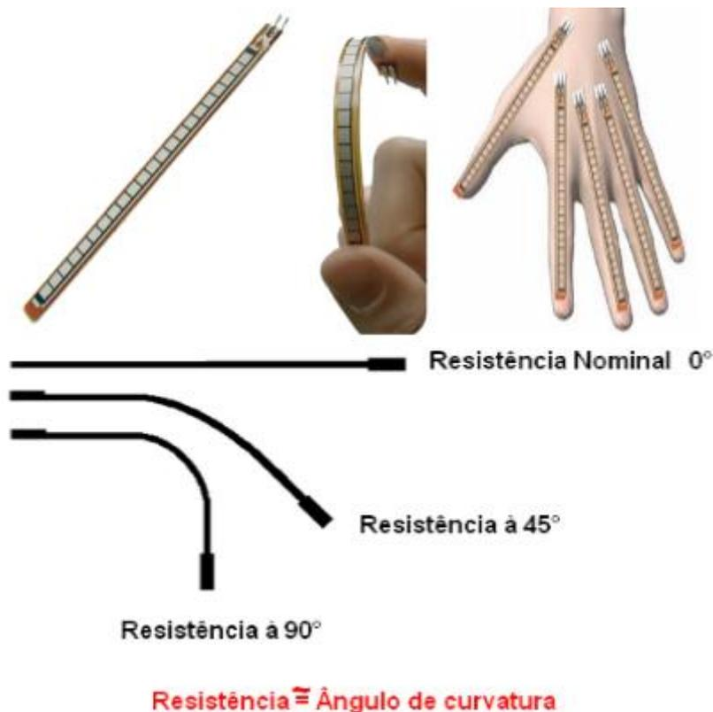
Quando o substrato é dobrado, o sensor produz uma saída de resistência correlacionada com o ângulo de curvatura, quanto maior o ângulo, maior é o valor da resistência.
