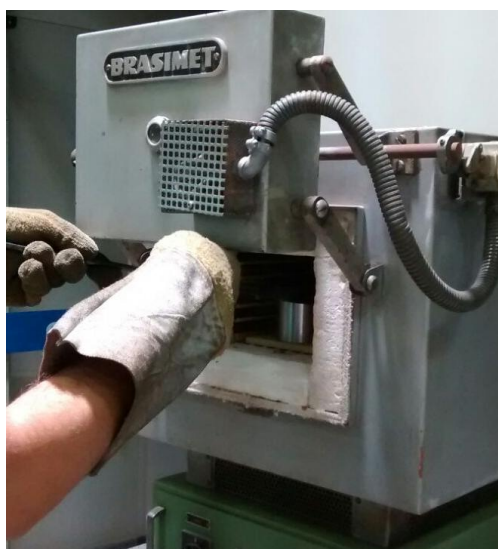
Figura 5 – Início do tratamento térmico com o carregamento do forno.
