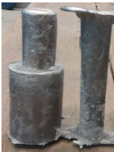
Figura 2 – Peça fundida com canais de enchimento e alimentação.
