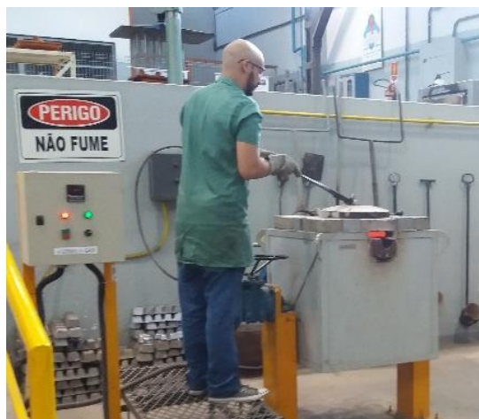
Figura 1 – Preparação da liga no forno.
