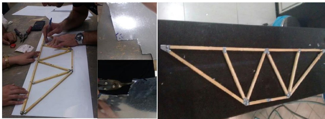
Figura 8: Estrutura da treliça pronta e desenho e corte das ligações das barras na chapa de zinco. Fonte: própria.
