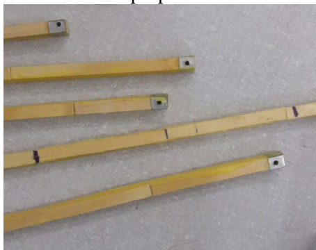
Figura 7: Detalhe das chapas de zinco nas extremidades das barras. Fonte: própria.
