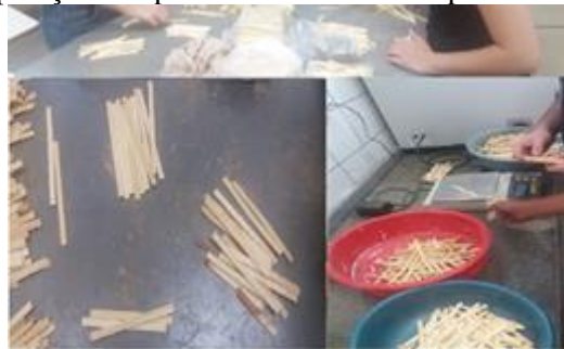
Figura 6: Separação dos palitos – danificados e pesos diferentes. Fonte: própria.
