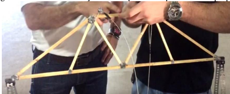
Figura 5: Estrutura da treliça com os aparatos e apoios. Fonte: própria.
