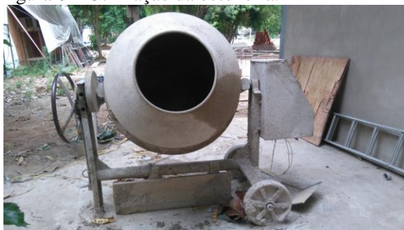
Figura 8 – Utilização da betoneira.
