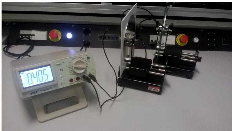
Figura 5: Capacitores associados em paralelo.
