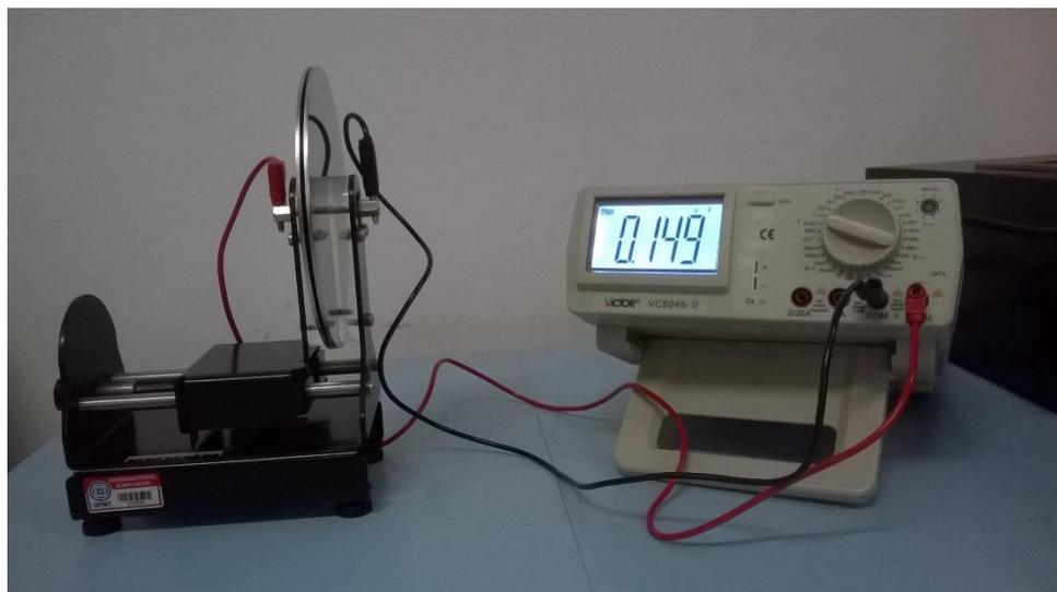
Figura 1: Capacitor utilizando o ar como meio dielétrico, conectado a um capacitômetro.
