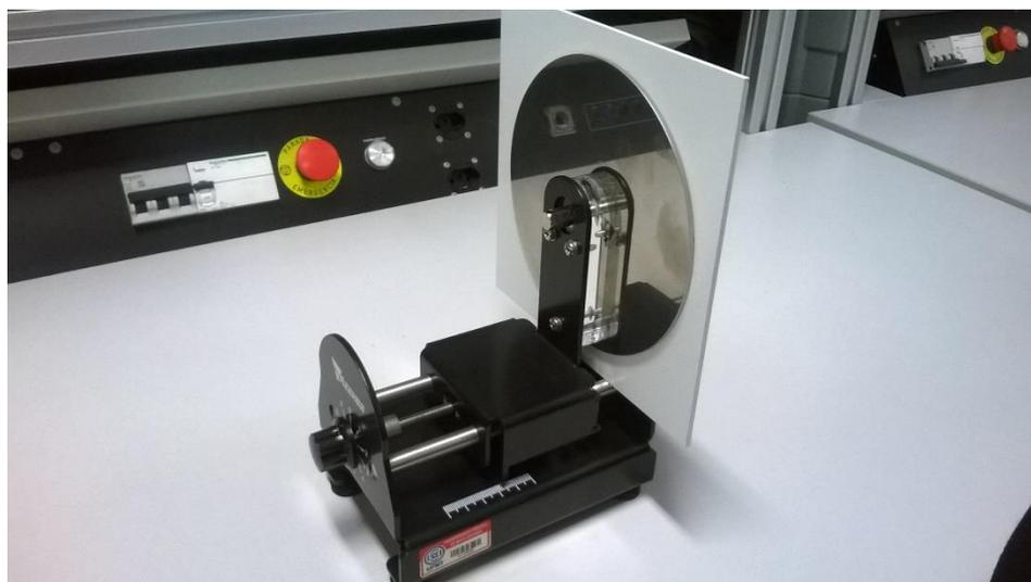
Figura 2: Capacitor utilizando uma placa de pvc como meio dielétrico.
