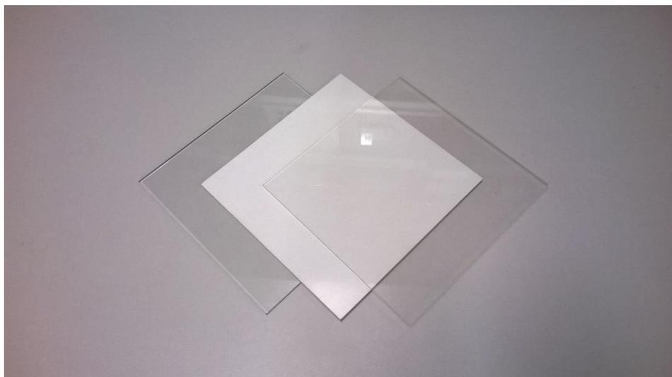
Figura 3: Placas de acrílico, pvc e vidro, utilizadas como dielétrico.
