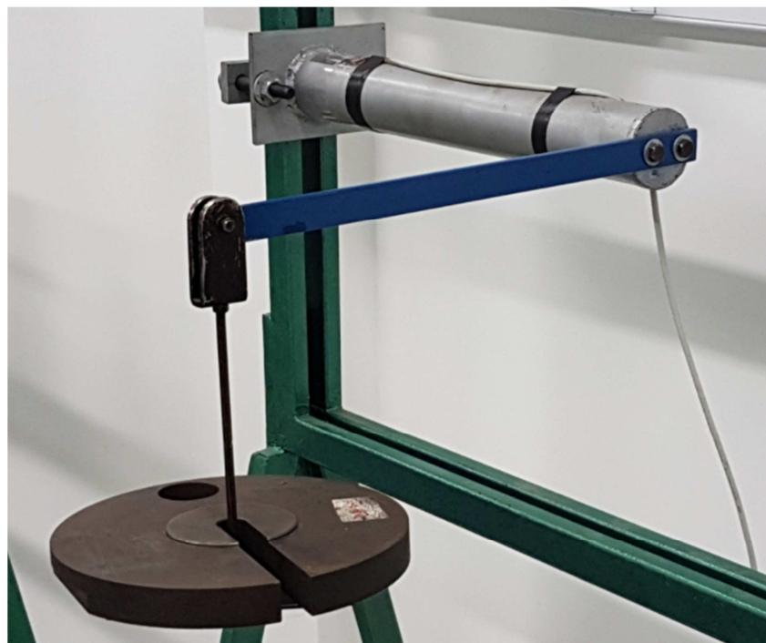
Figura 5 – Dispositivo em teste com suporte para as cargas utilizadas.
