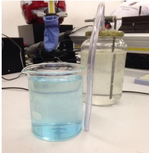
Por meio de uma fonte, foi aplicada uma diferença de potencial nos eletrodos de carbono, a qual é responsável pela descarga de íons, onde ocorre perda de elétrons por parte dos ânions presentes na solução (oxidação) e ganho por parte dos cátions (redução). Através desse processo, dá-se a formação de gás hidrogênio no ânodo e oxigênio no cátodo. Pelo tubo, esses gases são transferidos ao béquer e aprisionados em bolhas. Como é possível observar na Figura 8.
