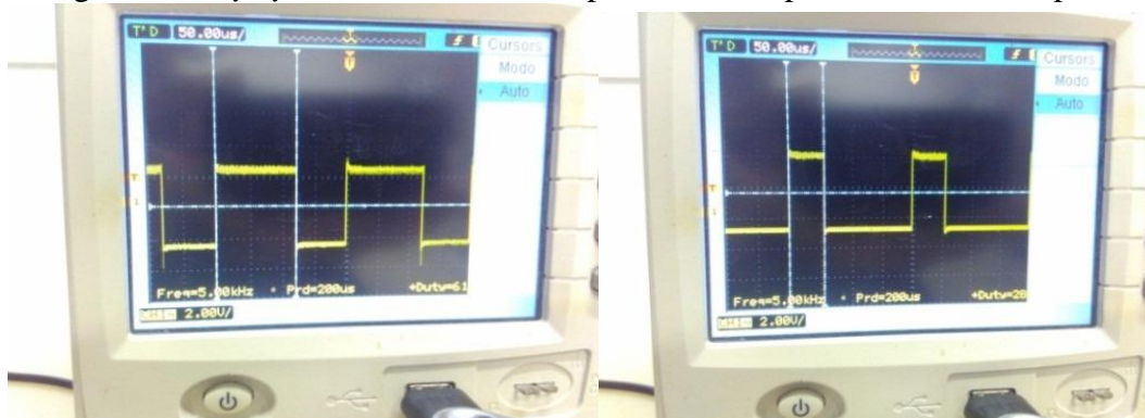
Figura-6 Duty cycle do PWM medido pelo osciloscópio no circuito receptor.
