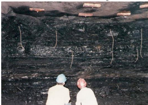
Figura 3 – Frente de lavra preparada para detonação. Criciúma SC. Turma de 1988. Fonte: acervo do Prof. Milton Brigolini Neme.
