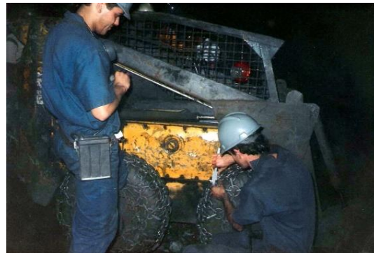
Figura 4 – Alunos medindo desgaste nas correntes antiderrapantes. Criciúma SC. Turma de 1988. Fonte: acervo do Prof. Milton Brigolini Neme.
