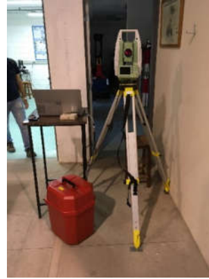
Figura 3 – Prisma posicionado próximo de um relógio comparador e a Estação Total utilizada no ensaio.
