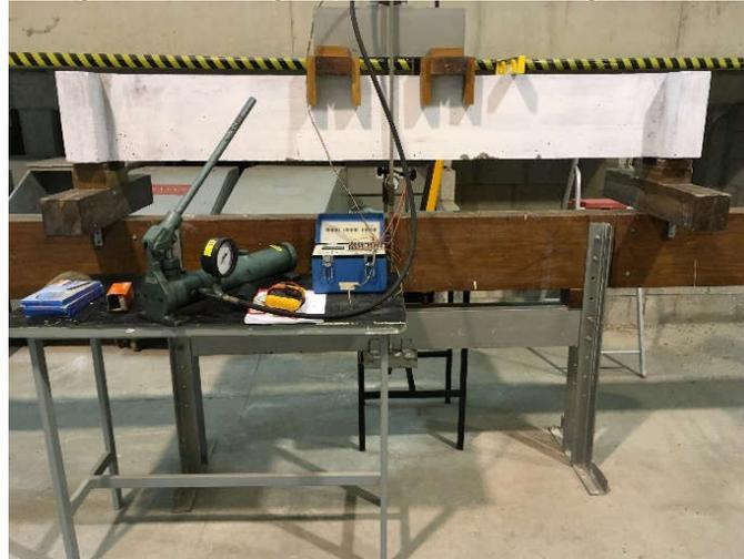
Foi utilizada uma célula de carga para realizar a leitura dos carregamentos. No meio do vão da viga foram colados strain-gages nas duas barras de armaduras posicionadas próximas a face inferior da viga com o objetivo de se obter a deformação nas armaduras. Um relógio comparador foi posicionado no meio do vão da viga para leitura dos deslocamentos verticais. Para realizar a leitura dos valores de carregamentos e deformações das armaduras foi utilizado um sistema de aquisição de dados digital.
