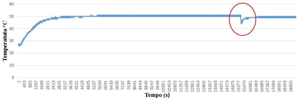
Nota-se que em pouco tempo após a perturbação o sistema corrige-se automaticamente devido a realimentação do sistema com a ação do controlador
