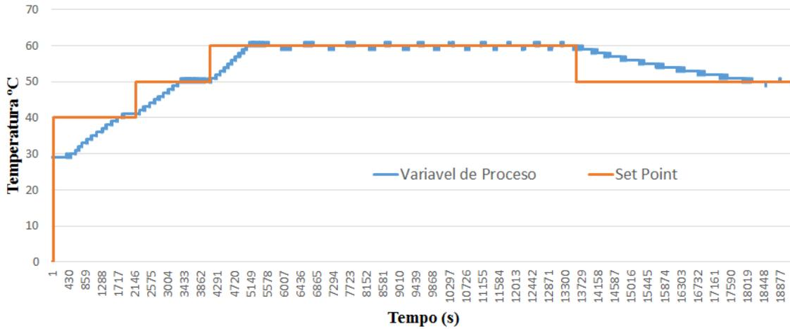
Figura 9 – Resposta da ação de controle, mediante a variação do setpoint
