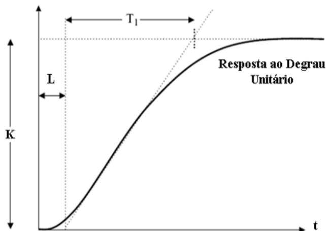
Caso o sistema seja de primeira ordem, que é o caso específico de um sistema térmico, sistema esse utilizado neste artigo, são calculados três constantes:  $T_1$  (constante de tempo),  $L$  (tempo de retardo) e  $K$  (ganho).
