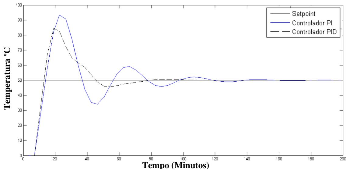
Observa-se que a resposta do sistema é muito lenta para chegar ao regime permanente, devido à ação derivativa, além disso o overshoot é alto, algo indesejado ao nosso sistema por conta das características físicas da água. Deste modo partiu-se para um ajuste dos parâmetros do controlador PID. A simulação após o ajuste pode ser observada na Figura 6.
