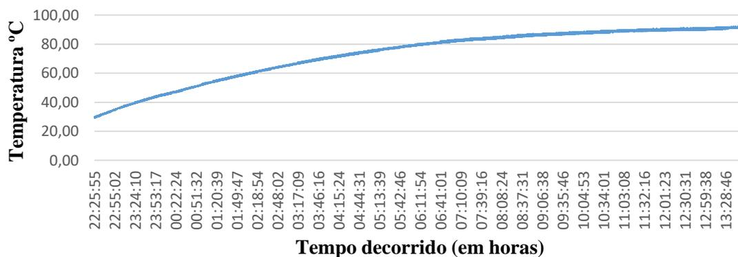
O sistema térmico levou cerca de 10 horas e 15 minutos para apresentar estabilidade, com um tempo de amostragem de 0,033 min. Segundo o método do degrau de Ziegler-Nichols, foi traçada uma reta na região linear do gráfico obtido. Deste modo, os valores obtidos para a constante de tempo, o tempo de retardo e o ganho, necessários para uma função de transferência de primeira ordem (Equação 1) são, respectivamente: 585 minutos; 7 minutos.
