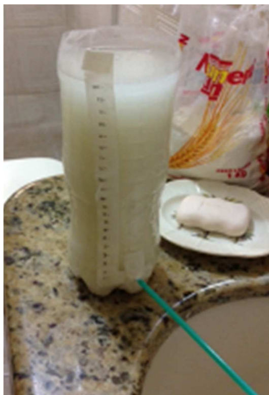
Figura 1 – Viscosímetro capilar caseiro desenvolvido pelos alunos da disciplina de fenômenos de transporte
