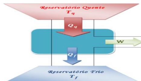
Figura 3- Desenho esquemático do funcionamento de uma máquina térmica, sendo o Q_q calor do reservatório de maior temperatura (Reservatório quente a uma temperatura T_q ) e Q_f calor do reservatório de menor temperatura (reservatório Frio a uma temperatura T_f ).
