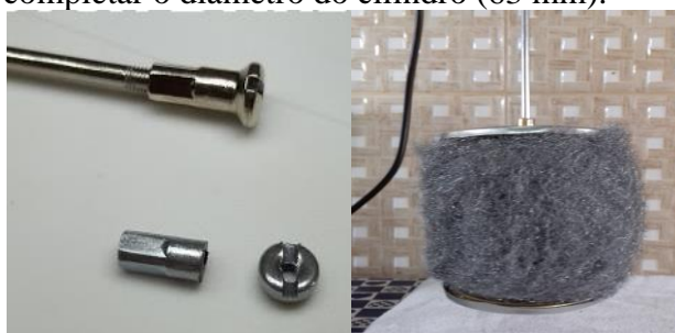
Figura 13 e 14 – Haste do pistão deslocador com a porca cortada; haste do pistão envolvido com a lã de aço.
