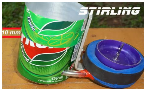
Figura 6– Cabeçotes encaixados em 1 mm.
