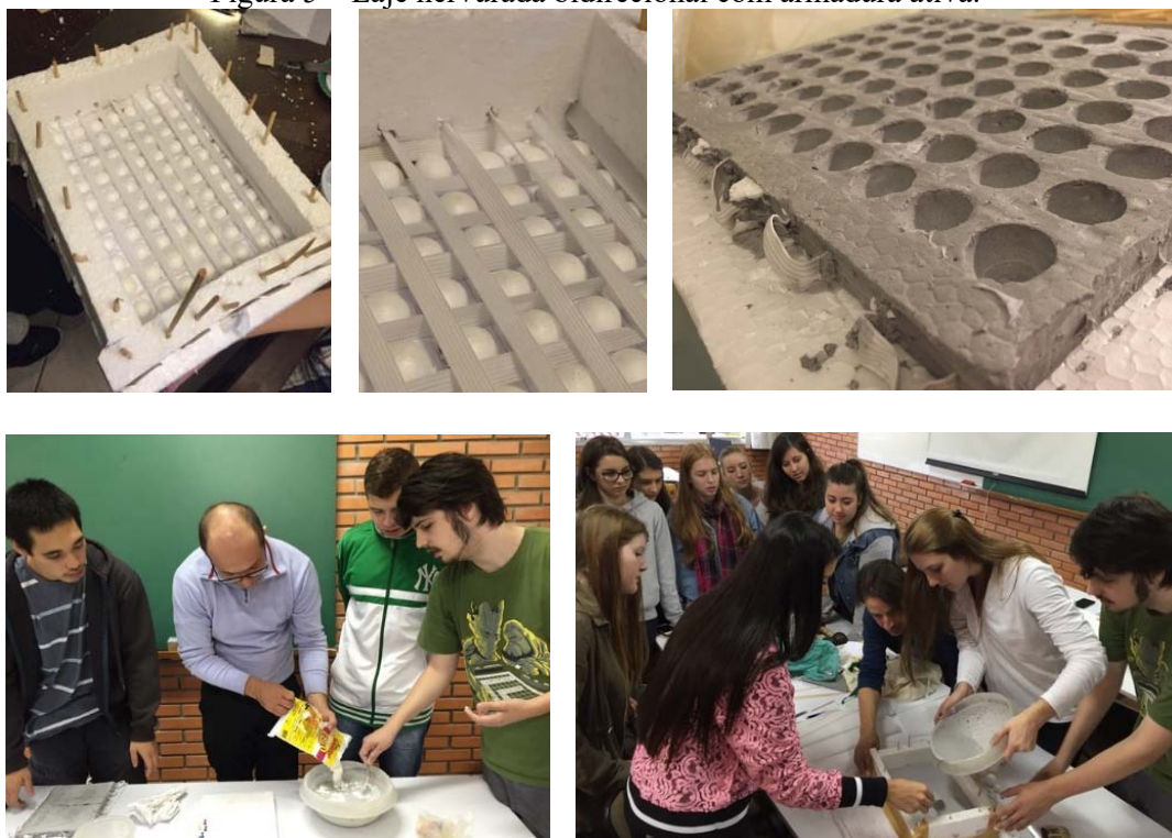
Figura 5 – Laje nervurada bidirecional com armadura ativa.
