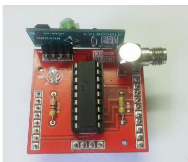
Figura 3 - Módulo de RF. Fonte: Elaborada pelo autor.
