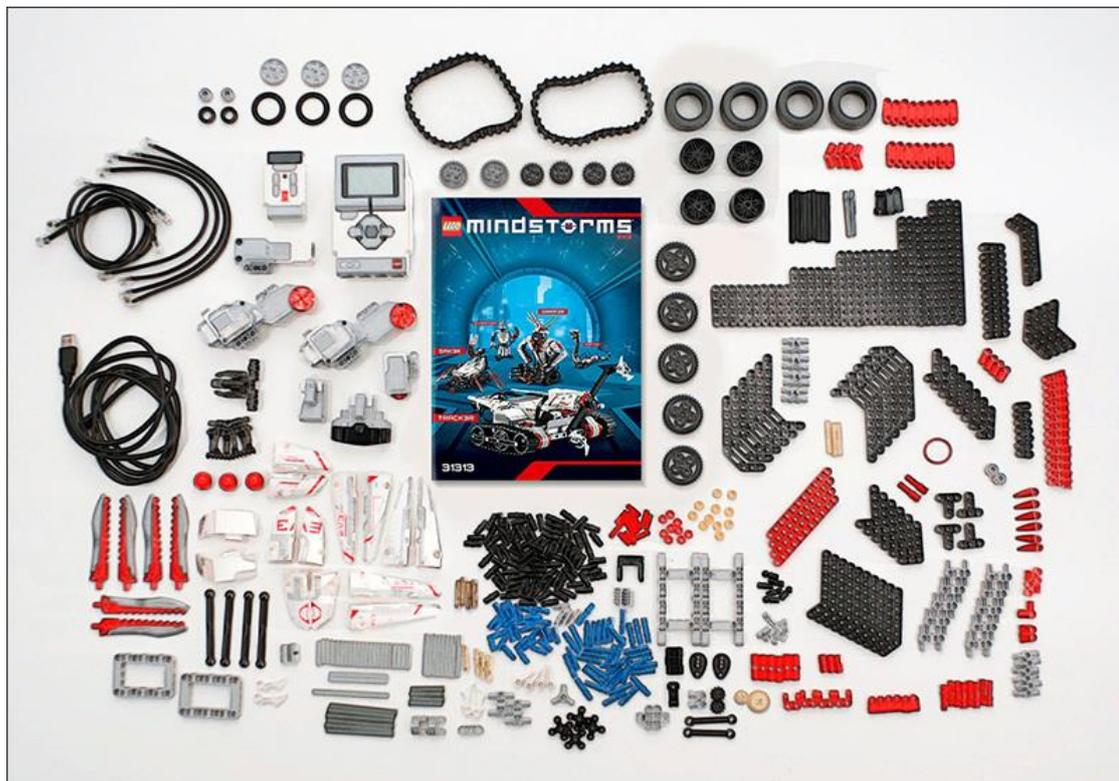
O modelo escolhido para esse presente trabalho pode ser visto abaixo na “Figura 2”. Ele possui 2 rodas motoras paralelas de tração independente, 1 roda livre (roda boba), 2 motores, 1 sensor ultrassônico, eixos para ajuste das rodas, engrenagens, polias, cabos de ligação e o bloco programável, que é a parte inteligente.
