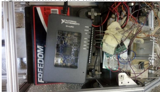
Figura 5 – Módulo NI myRIO conectado ao robô móvel.
