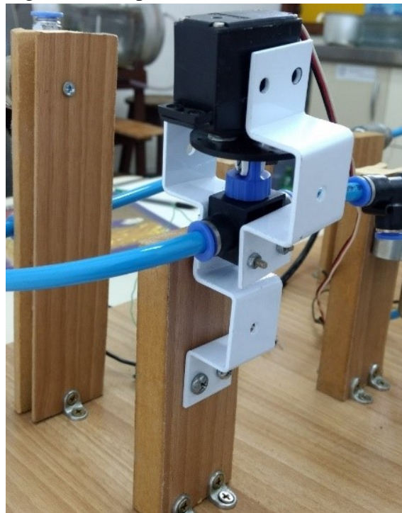
Figura 6 – Válvula reguladora de pressão.
